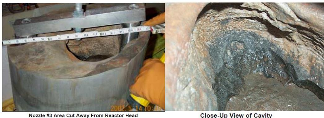
図 A-2.2 上蓋低合金鋼のほう酸腐食<sup>(2), (3)</sup>
