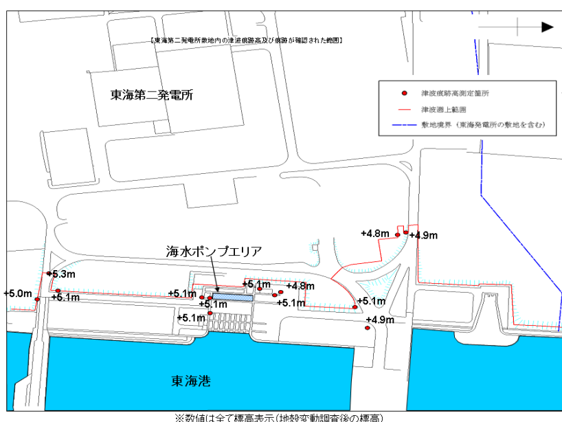
図 8.3-1 東海第二発電所 津波の浸水状況
